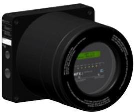
Der MFX\_4 Controller ist die zentrale Recheneinheit des MFX\_4 Systems. Er ist in zwei Gehäusevarianten als explosionsgeschützt (Ex) und nichtgeschütztes Gerät erhältlich, wobei die Funktionalität der Elektronik identisch ist. Abhängig von der Bauform kann er sowohl in der Messwarte als auch unter extremen Witterungsbedingungen im explosionsgefährdeten Außenbereich eingesetzt werden.
